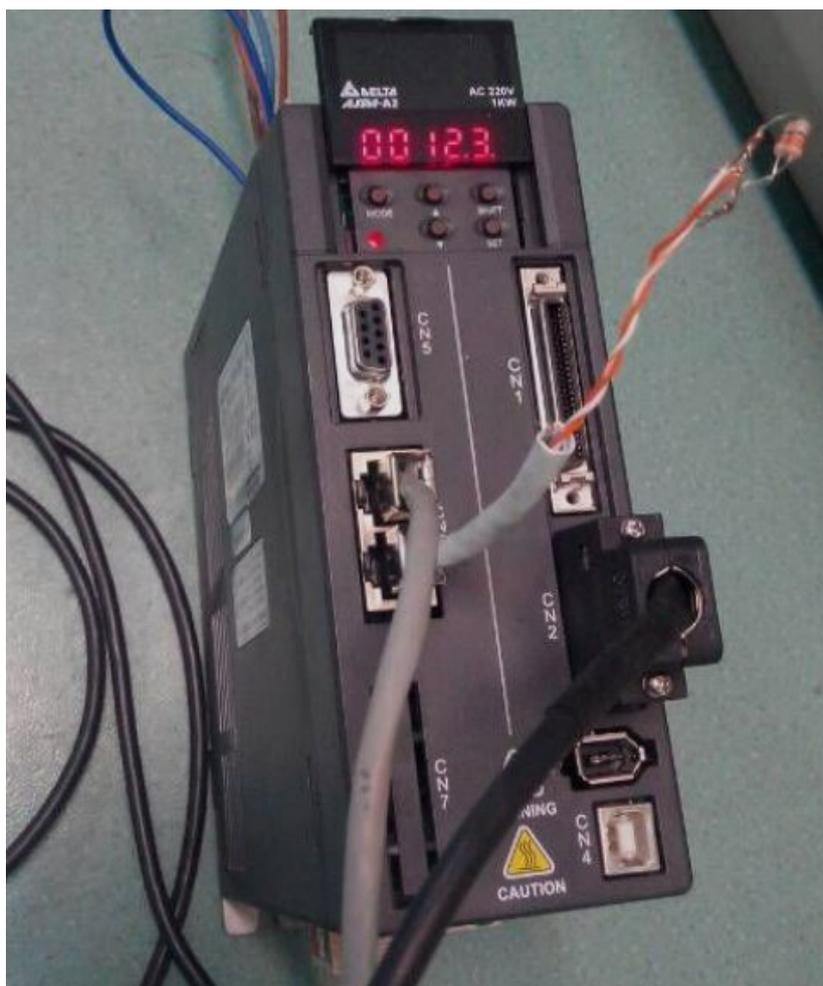
图 8 伺服驱动显示屏上显示 PLC 写过来的值
